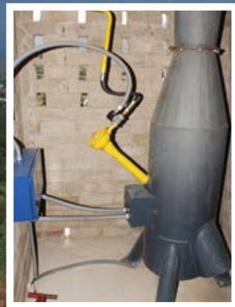
► Este sistema logra modificar la dinámica microfísica de la nube e inhibir la formación del granizo.
